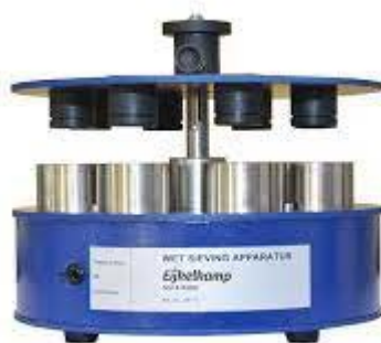
Figure 2 – Dispositif Ejkelkamp de tamisage humide (WSA) pour la détermination de la stabilité des agrégats
