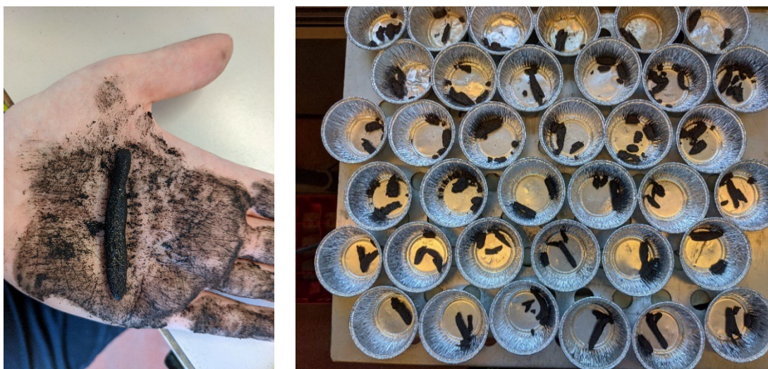
Figure 8 – Limite de plasticité: Test du boudin
