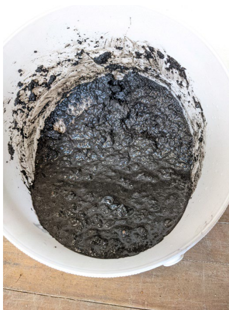
Figure 4 – Test bassine. A: le Technosol se maintient et seule l'eau s'écoule dans la pente (catégorie 1), en B: le Technosol flue et coule (catégorie 3)
