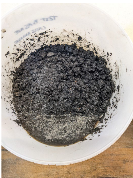
Figure 4 – Test bassine. A: le Technosol se maintient et seule l'eau s'écoule dans la pente (catégorie 1), en B: le Technosol flue et coule (catégorie 3)
