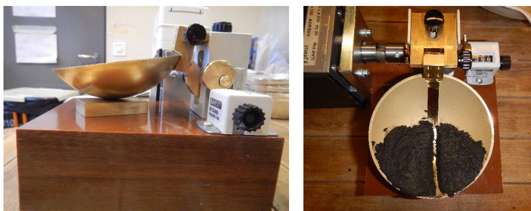
Figure 6 – Détermination de la limite de liquidité: Bol de Casagrande
